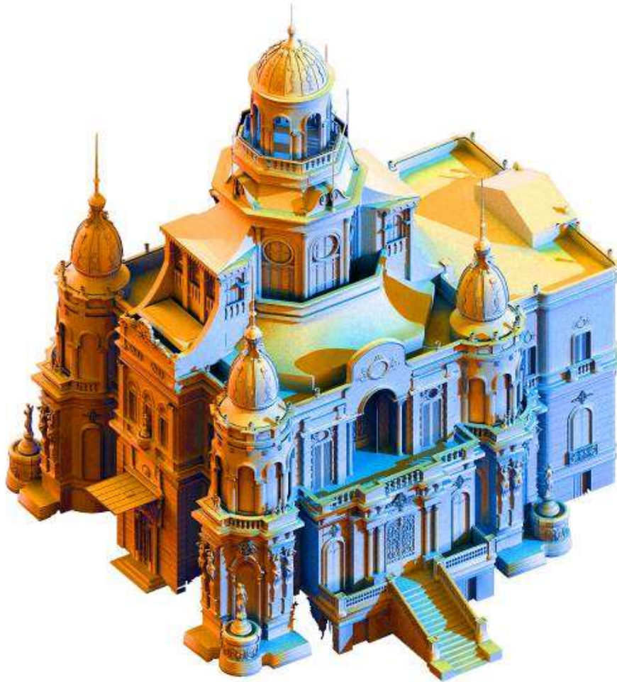
نموذج رقم (٩) ثلاثي الأبعاد لمجسم قصر السكاكيني باستخدام تقنيات الرفع المساحي والفتوجراممري
