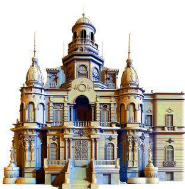
نموذج رقم (٦) لنتائج استخدام الرفع المساحي والفوتوجراممري للواجهة الامامية لقصر السكاكيني
