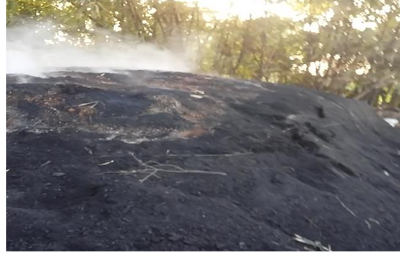
صورة (٩) تغطية الرصات بالدبسة داخل الكمورة لبدء عمليات الحريق بناحية كتامة ٢٠٢١/٥/٢٢
