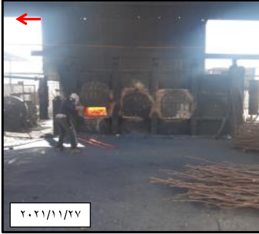
صورة (٢) أفران الصهر بصناعة تشكيل وتشغيل المعادن
